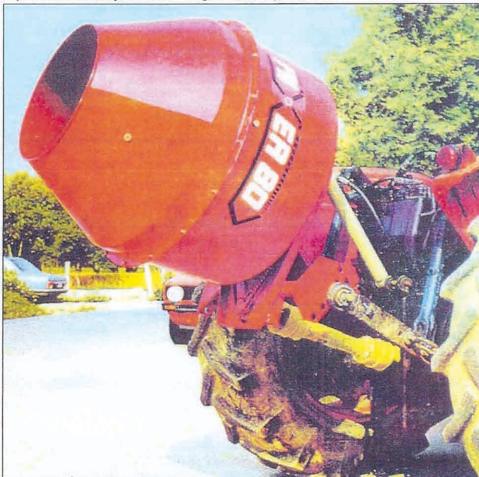
**CONSTRUCCION:** El tambor mezclador consiste de dos piezas de chapa de 3 y 2,5 mm de espesor respectivamente completamente estampada, atornilladas y sin ningun cordón de soldadura. Todas las partes que soportan el mezclador-agitador, son fijadas con bulones para facilitar el desmontaje, sustitución, almacenamiento y transporte.
